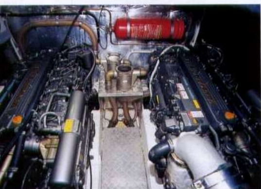
In sala macchine, due Yanmar da 440 cv offrono la massima affidabilità.
